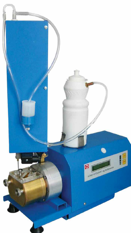
Konsystograf do badania wodochłonności mąki
